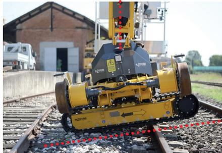
Die RR11T wird von einem leistungsstarken 10,5-kW Dieselmotor angetrieben. Als weitere Option kann die Maschine mit Lithium-Ionen-Batterien für den vollelektrischen Betrieb bestellt werden. Somit ist die RR 11T bestens für den Einsatz in Tunneln, U-Bahnen und im Innenbereich von Gebäuden wie z. B. Hallen oder Bahnhöfen einsetzbar.
