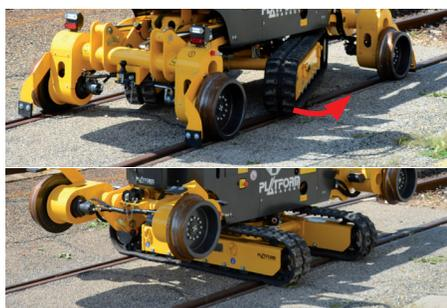
Das um 90 Grad schwenkbare Raupenfahrwerk ermöglicht ein einfaches, schnelles und sicheres Ein- und Ausgleisen der RR11T.
