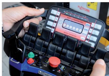
Die Bedienung der Maschine mittels Fernsteuerung kann vom Boden oder vom Korb aus erfolgen. Vom Boden aus, kann die Maschine ohne Last im Korb mit der Fernsteuerung problemlos gefahren werden, z. B. beim Ein- und Ausgleisen, Verladen, usw.
