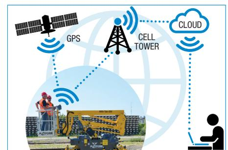
Tele-Diagnose und Fernsteuerung (optional). Durch die Telediagnose und Fernsteuerungsoption, können wichtige Daten kabellos übertragen und der Betriebszustand sowie Standort der Maschine ausgelesen werden.
