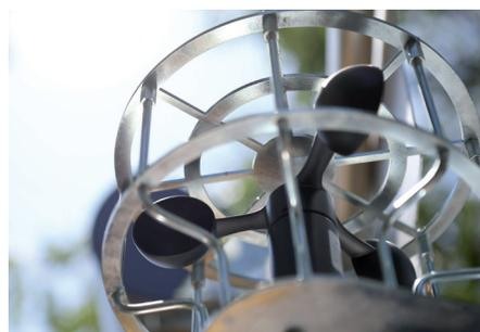
Windmesser (optional). Warnt den Bediener optisch und akustisch vor Erreichen der maximal zulässigen Windgeschwindigkeit von 45 km/h (12,5 m/s), um den sicheren Betrieb bei aufkommender Windbelastung sicherzustellen.
