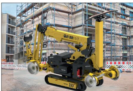
Die Maschine bietet hohe Flexibilität im Betrieb, da sie sowohl auf Raupen im freien Gelände als auch auf der Schiene verwendet werden kann, ohne dass eine zusätzliche Stabilisierung erforderlich ist. Dies ermöglicht den Einsatz selbst in engen Bereichen.
